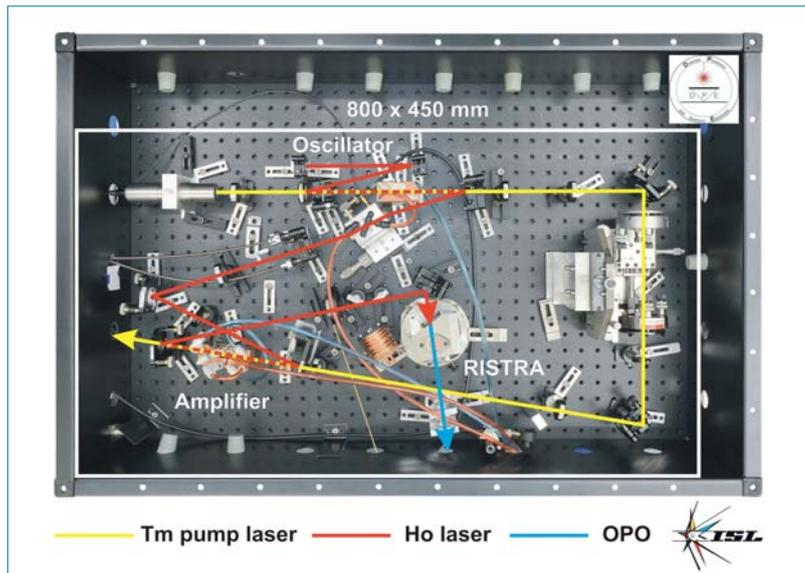
Sicht von oben auf das gesamte Lasersystem für die Erzeugung von 6.45 Mikrometer Strahlung mit dem Ho-Laser gepumpt durch einen Tm-Faserlaser und die nichtlineare Frequenzkonversion basierend auf OPO (Optisch-Parametrischer Oszillator). Foto: French-German Research Institute of Saint-Louis
